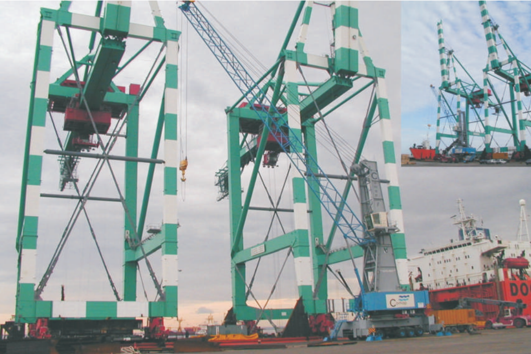
CARICO AD AUGUSTA N°2 PORTACONTAINERS SU NAVE DOCKWISE PER TRASPORTO IN MALESIA ESEGUITO DALL'IMPRESA PORTUALE C.O.M.A.P.
