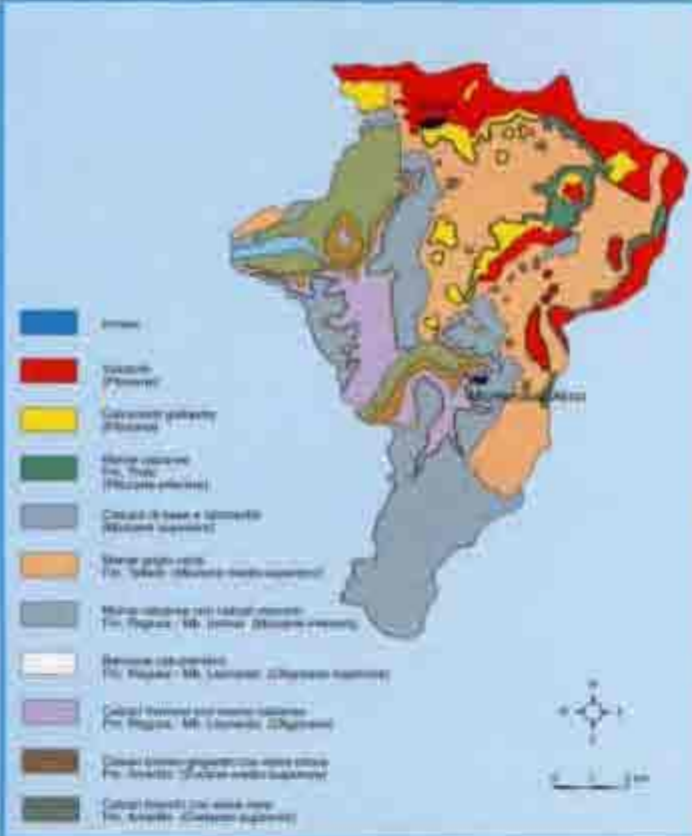
Geologia del bacino idrografico sotteso dallo sbarramento Geology of the catchment basin subtended by the barrage
