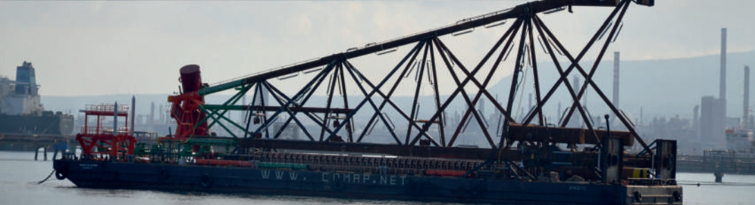
Rimorchio della Jacket "Fauzia" da Augusta ad Ancona con la Barge 92 e l'assistenza del rimorchiatore F.lli Fazlo "Comap"
